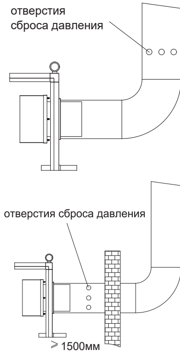
рис. 8. Установка трубы дымоудаления
