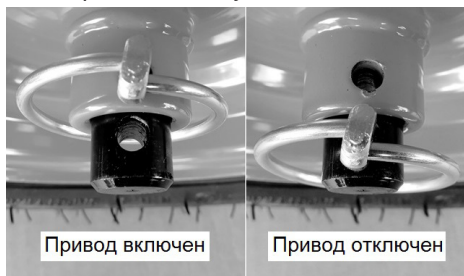
Рис. 28 Перестановка шплинта на левом колесе
