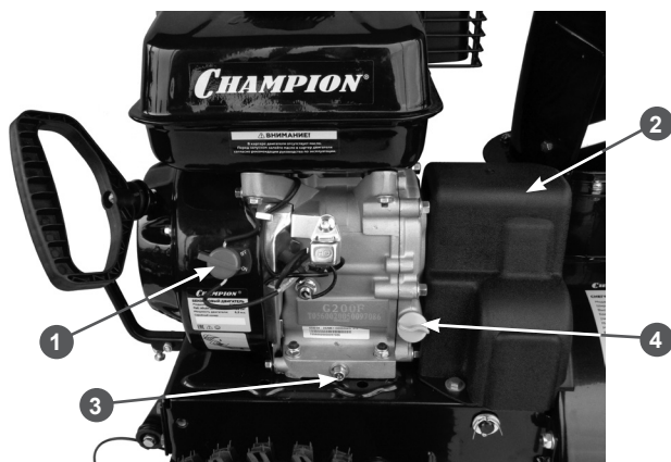
Рис. 3 Основные узлы и органы управления двигателя (вид справа)
