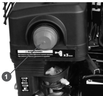
Рис. 26 Расположение ручного топливного насоса
