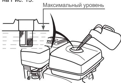
Рис. 13 Максимальный уровень топлива в топливном баке
