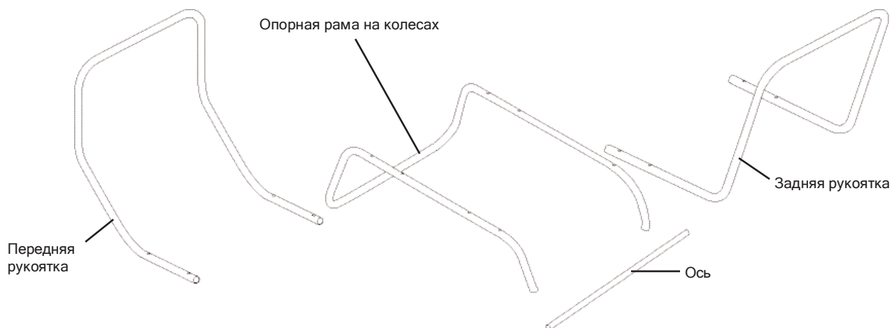
Рисунок 5. Компоненты рамы, модели TCA 35 / 50 / 60
