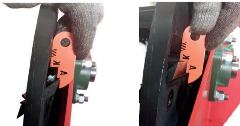
Рис.4. Выставления ножей по кондуктору
