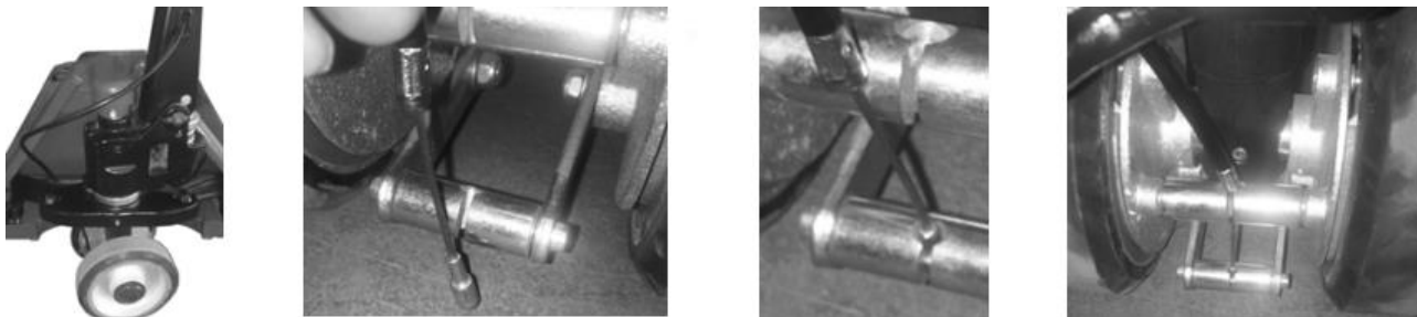
Рис. 9: Установка стояночного тормоза
